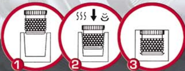
Verfahrensablauf (Bsp. Warm- und Ultraschalleinbau)
